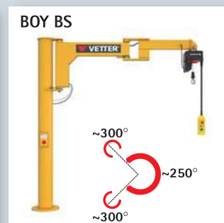
Typenbezeichnung: BOY BS Tragfähigkeit: 63 – 250 kg Ausladung: 2.000 – 4.000 mm
