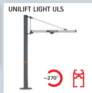
Typenbezeichnung: UNILIFT LIGHT ULS Tragfähigkeit: 100 kg 1 Ausladung: 1.835 - 2.835 mm Schwenkbereich: nominal 270° Model: UNILIFT LIGHT ULS Capacity: 100 kg 1 Outreach: 1,835 - 2,835 mm Slewing range: nominal 270°
