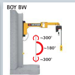
Typenbezeichnung: BOY BW Tragfähigkeit: 63 – 250 kg Ausladung: 2.000 – 4.000 mm
